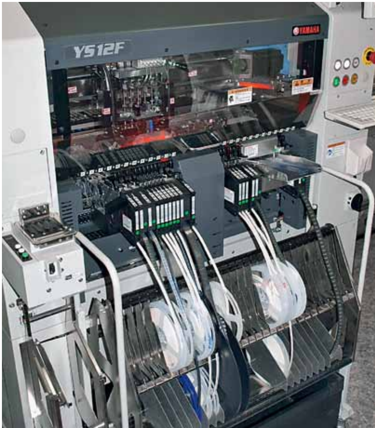
Автомат установки компонентов Yamaha YS12F
