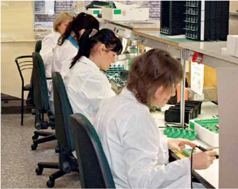
Участок ручного монтажа. Сборка источников питания
