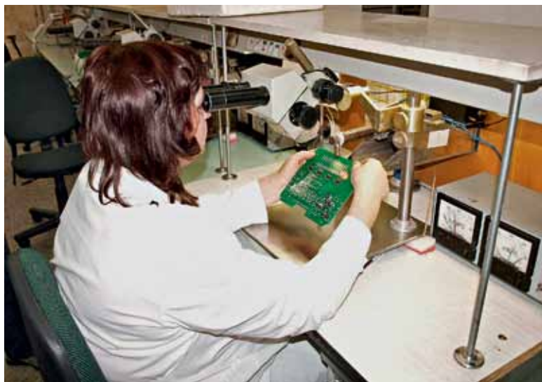
Участок ремонта. Используется "воздушный паяльник" собственного изготовления
